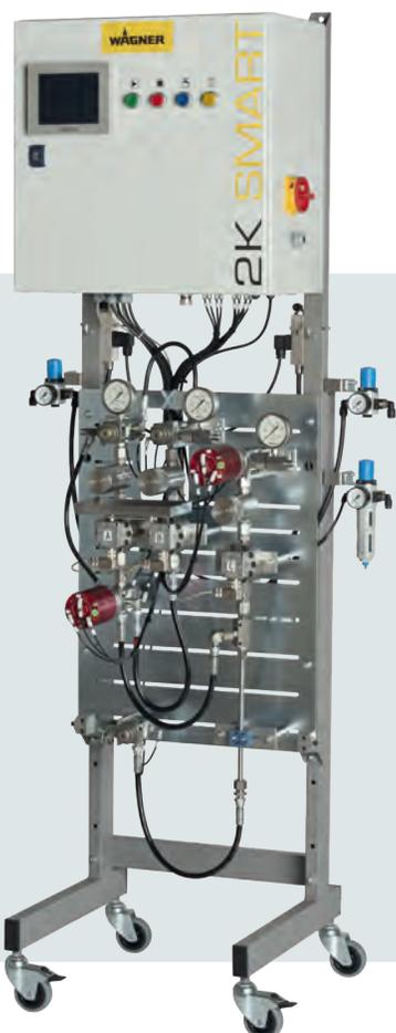
**A unidade de mistura e dosagem WAGNER 2K Smart, opcionalmente com medidor de vazão sem contato, pode ser usada em qualquer aplicação onde tintas de várias cores 2K ou 3K são processadas.**
