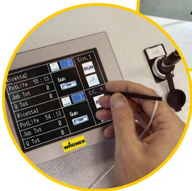
INTELLIMIX *touch DFS* é a solução perfeita para gerenciar duas diferentes seções de fluido ao mesmo tempo, usando produtos diferentes, mesmo que não possam ser usados juntos como água e solvente ou esmalte epoxy e poliuretano.
