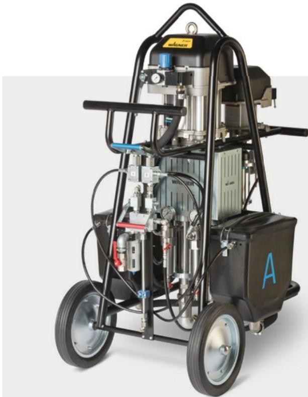
Onde quer que sejam usados materiais 2K altamente viscosos, o WAGNER PROTEC 2K faz tanto a dosagem precisa dos componentes quanto a mistura complexa e demorada.
