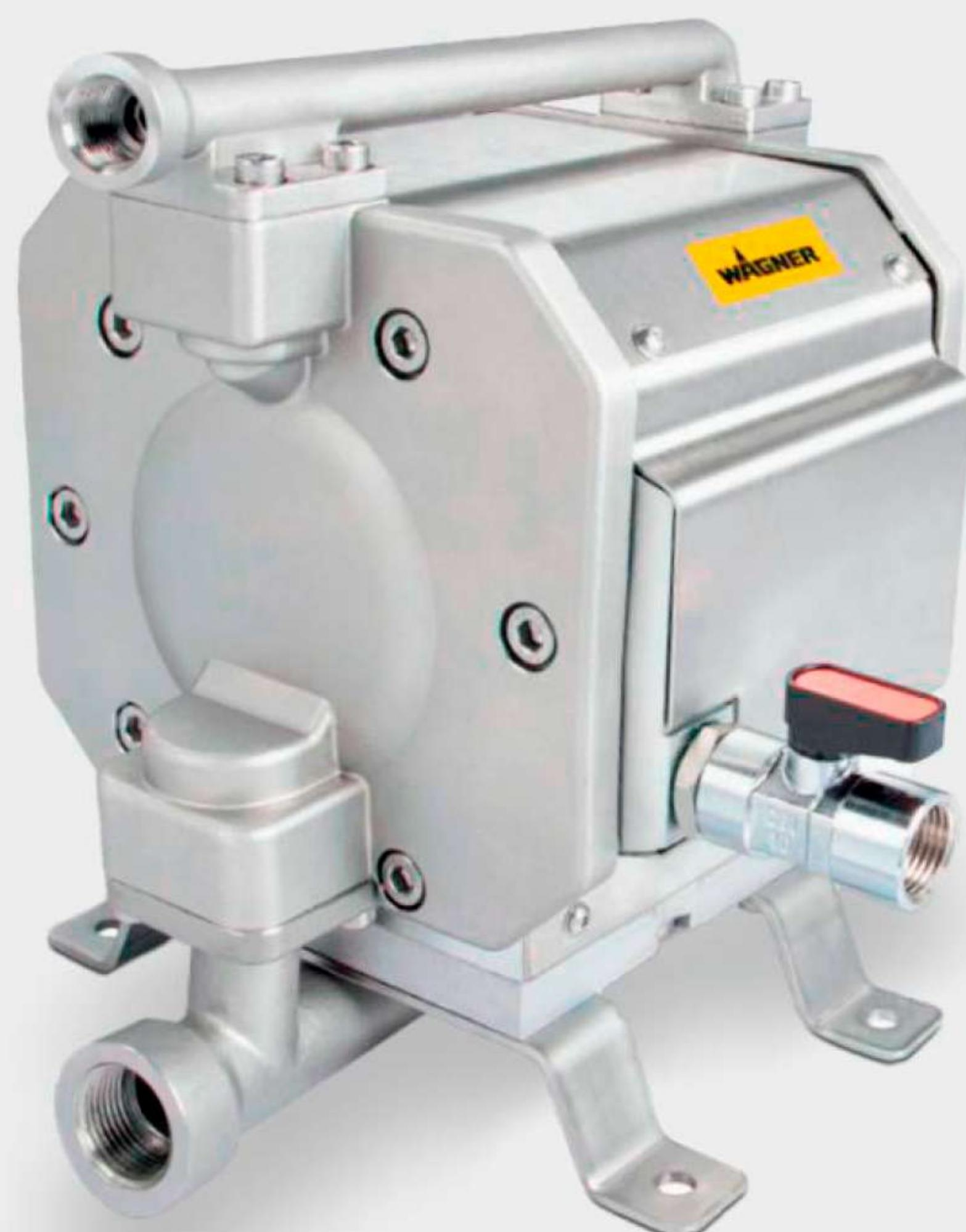
A bomba é indicada para todas as aplicações de airspray ou abastecimento onde a pressão de material exigida de uma bomba de duplo diafragma 1:1 não é alta o suficiente. O Unica 3-215 oferece maior pressão para entrega confiável de materiais de revestimento com alto teor de sólidos e maior viscosidade. É adequado para sistemas com operação de várias pistolas de pulverização e longas linhas de mangueira ou sistemas de recirculação onde o material está em constante movimento.
